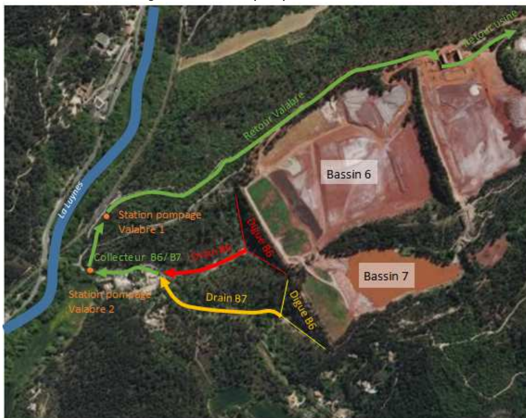
Figure 14 : Schéma de principe de fonctionnement des drains
