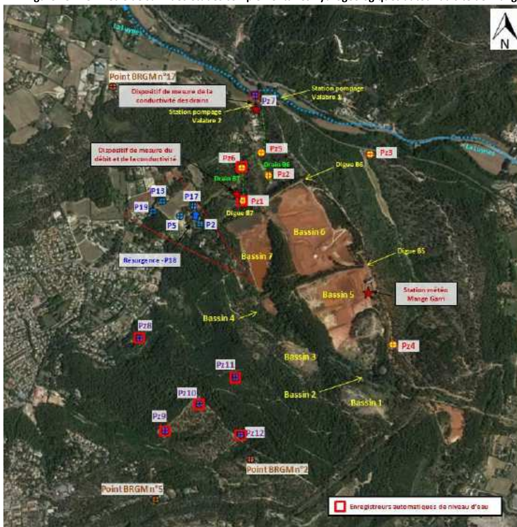
Figure 18 : Périmètre de suivi des études complémentaires hydrogéologiques autour du site de Mange-Garri
